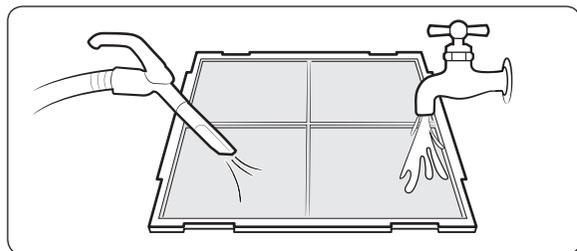
Vzduchový filter vyčistíte vysávačom alebo mäkkou kefkou. Ak je prach príliš ťažký, filter opláchnite pod tečúcou vodou a vysušte ho v riadne vetranej oblasti.
