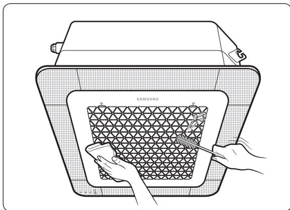
V prípade potreby povrch jednotky utrite jemne navlhčenou alebo suchou tkaninou. Nečistoty z menej prístupných častí odstráňte mäkkou kefkou.
